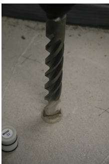
Kuva 1. Reikä porataan poravaralla 25 mm terällä. Mittareijän tulee olla sellainen että SH3 anturi voidaan asentaa tukevasti reikään.
