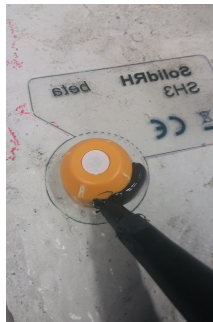
Anturi voidaan kiinnittää porareikään halutessa käyttämällä tiivistemassaa. Huomaa, asennusliimaa EI saa joutua anturin valkoiselle suojakalvolle!
